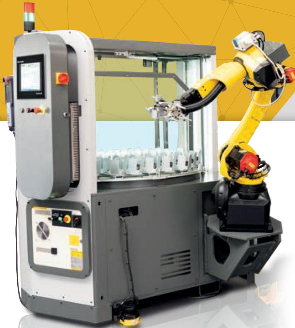
Mit CUBEBOX Blues RT können Rundmaterialen übereinander gestapelt werden, wodurch mehr Lagerplatz geschaffen und lange Wellenteile in das Automatisierungssystem integriert werden können.
